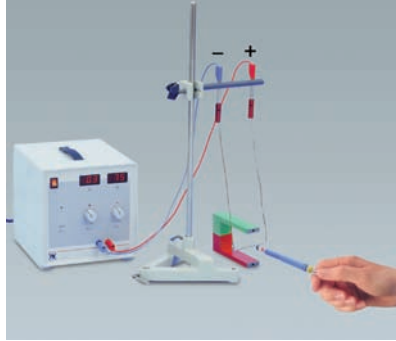
1 Der Kraftmesser zeigt die auf das Leiterstück wirkende Kraft an.
